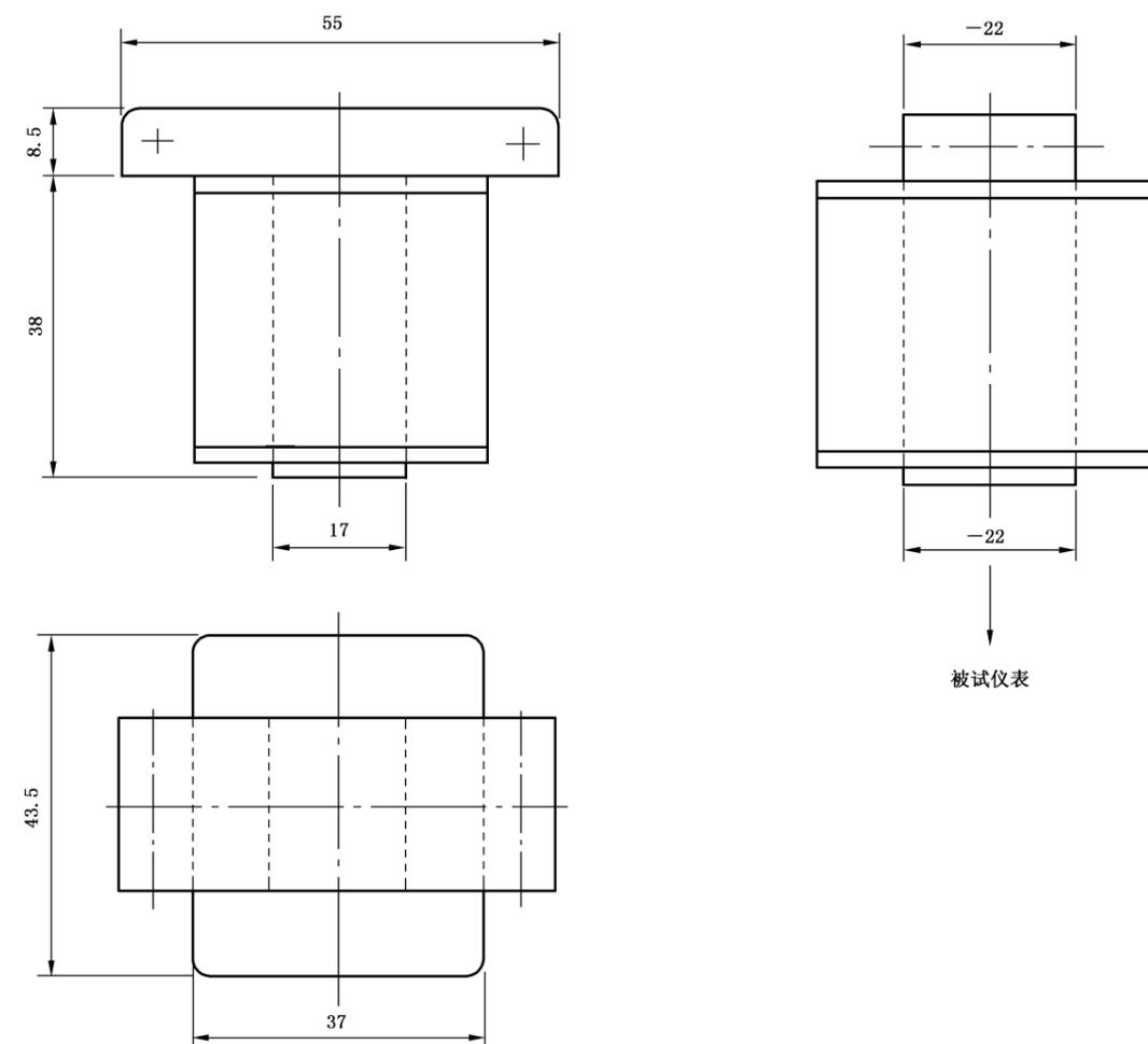
绕组参数举例:500匝  $\phi 0.6 \text{ mm}^2 / 0.28 \text{ mm}^2$
